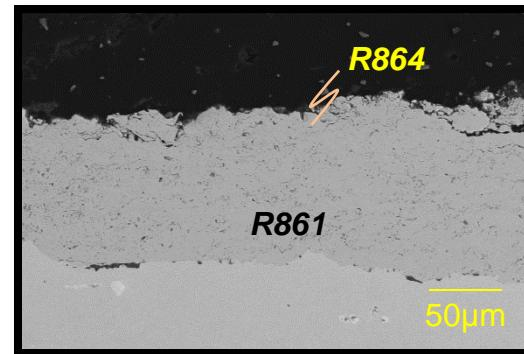
R863: *Poor splat cohesion*
